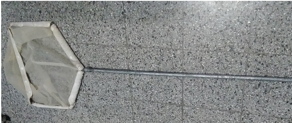
Gambar 3. Jaring kicking untuk pengambilan sampel gastropoda
