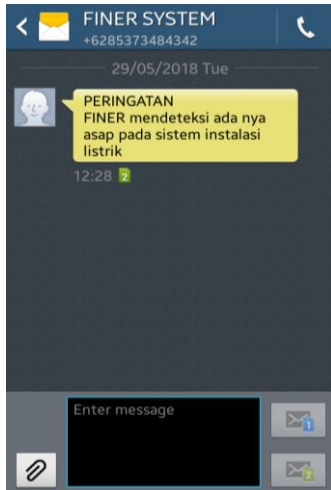
Gambar 12. Informasi yang dikirimkan GSM saat mendeteksi asap
