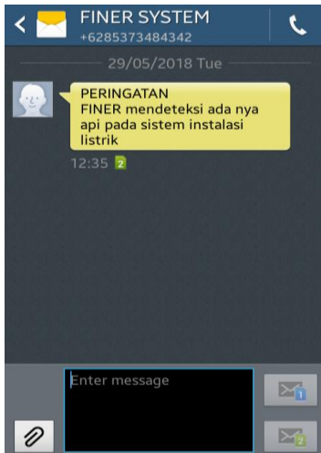
Gambar 13. Informasi yang dikirimkan GSM saat mendeteksi api
