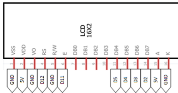
Gambar 7. Antarmuka LCD dengan Arduino Uno
