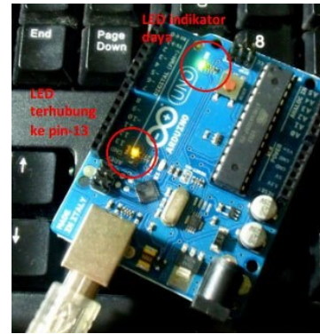
Gambar 2. Tampilan papan Arduino Uno dengan LED indicator [18]
