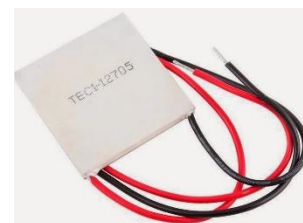
Gambar. 1 Suatu sel atau generator termoelektrik yang menerapkan prinsip seebeck untuk membangkitkan listrik.
