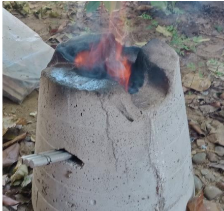
Gambar. 5 Tungku biomassa dengan batang aluminium.
