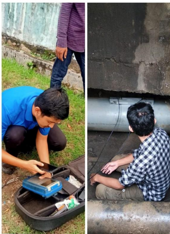
Gambar 12. Penggunaan Sensor OPTISONIC 6300 P di WTP PDAM Tirta Daroy
