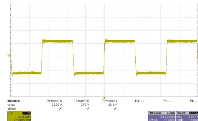
Gambar 19 Bentuk gelombang tegangan sisi primer trafo
