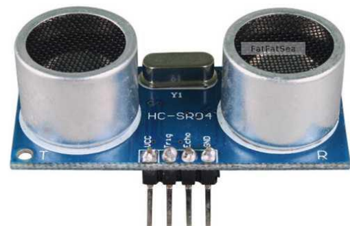
Gambar 5 Bentuk fisik sensor HC-SR04
