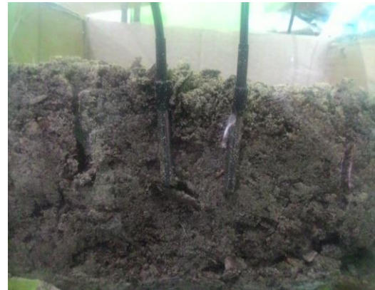
Gambar 8 Penempatan Sensor Suhu Pada Pupuk Kompos
