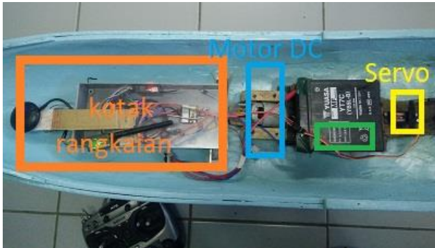
Gambar 12 Tata letak komponen dalam kapal tanpa awak
