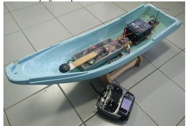
Gambar 11 Prototipe kapal tanpa awak dengan sistem kendali berbasis GPS
