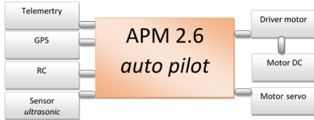
Gambar 9 Skema Rangkaian Sistem Pada APM 2.6 autopilot
