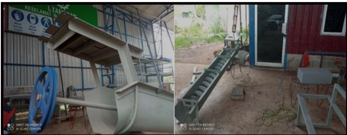
Gambar 4. Lokasi workshop yang digunakan sebagai tempat untuk melakukan pengelasan dan pelapisan bahan komposit untuk pembuatan kerangka turbin ulir
